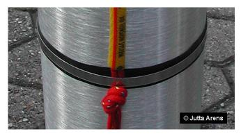
Als nächstes wird das Seil mit einer Schlauchschelle an der Flasche befestigt.
